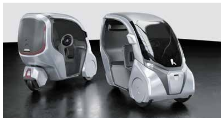
Studie: Der Hopper soll die Vorteile von Auto und E-Bike in einem neuen Fahrzeugkonzept vereinen. Die Höchstgeschwindigkeit soll bei 25 km/h liegen.
